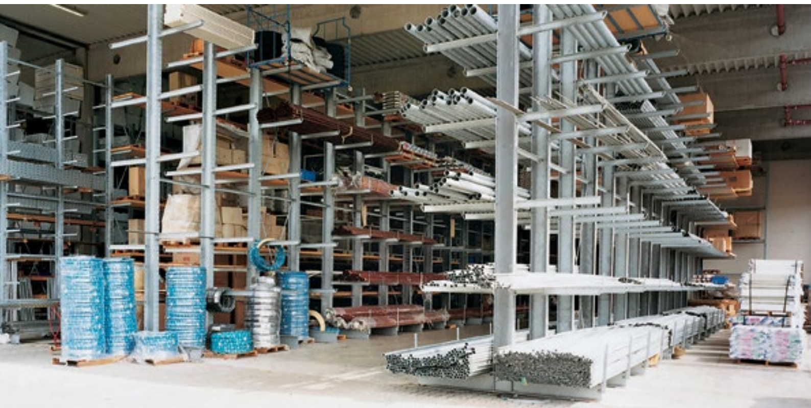
Kragarm-Doppelregale in feuerverzinkter Ausführung mit steckbarer Abrollsicherung. Branche: Sanitärgrößhandel
