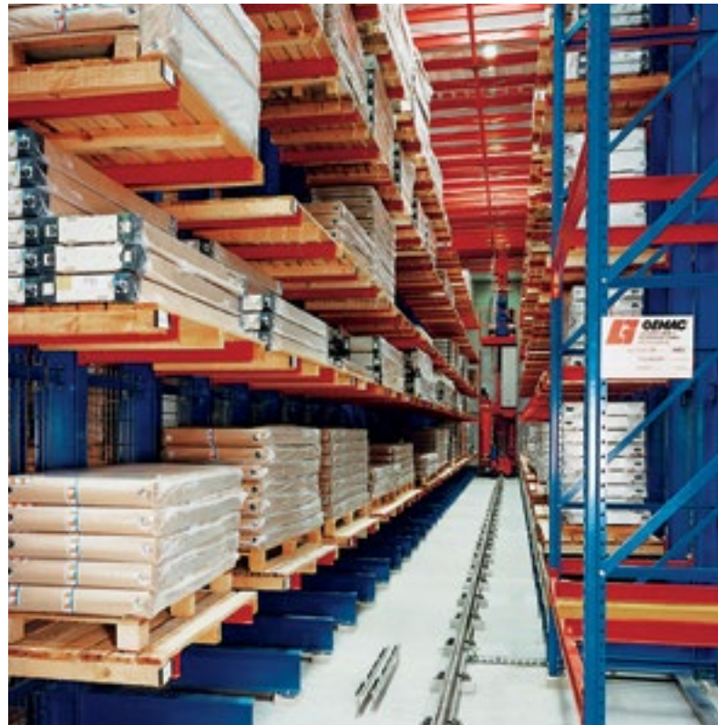
Kragarm-Einfachregal mit schienengeführttem RBG. Branche: Heizungs- und Sanitärgrößhandel
