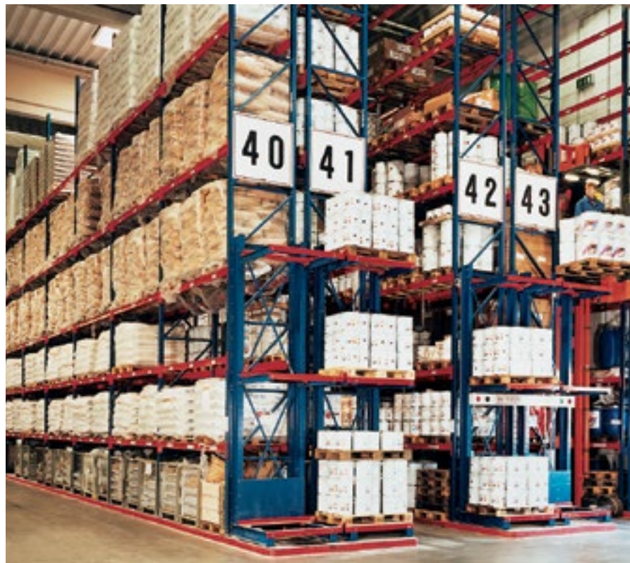
Mehrplatz-Palettenregal mit Führungsschienen. Branche: Chemische Industrie
