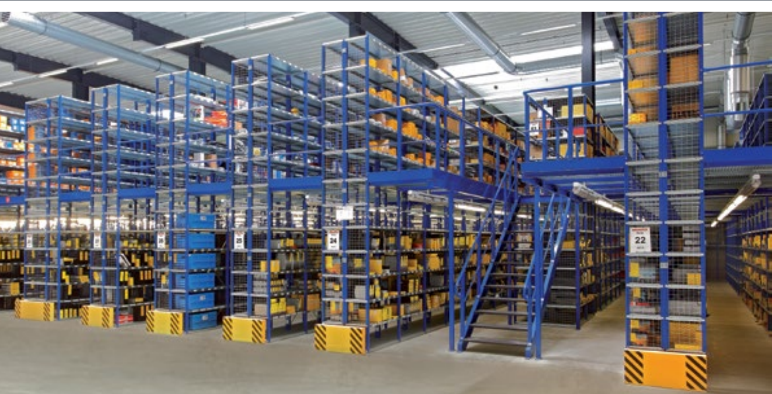
2-geschossige Fachbodenregalanlage mit Treppenaufgang, Schutzgeländer und Gitterstirnwänden.
