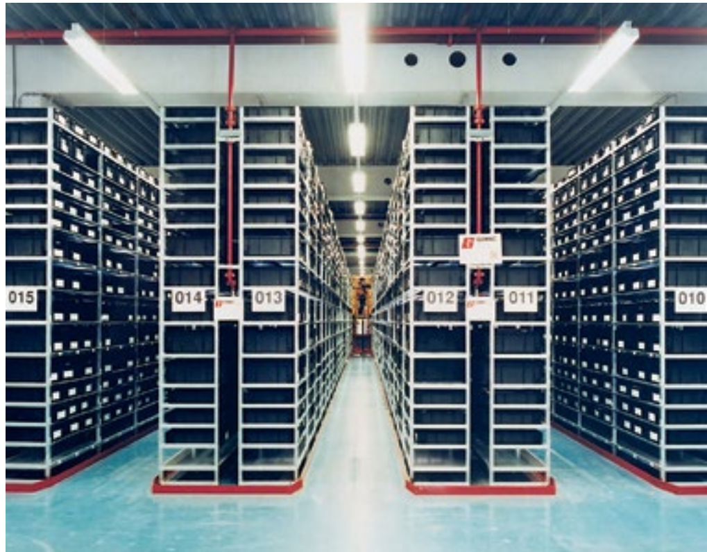
Fachbodenregalanlage für ein ESD-Lager, komplett verzinkt.
