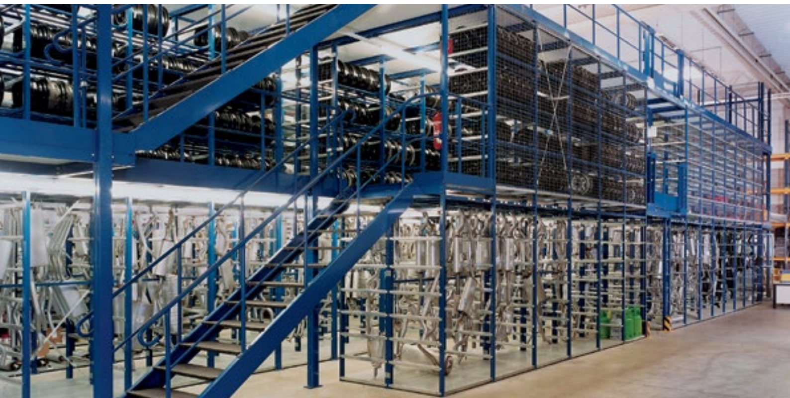
3-geschossige Fachbodenanlage mit vollflächiger Bühnenabdeckung.
