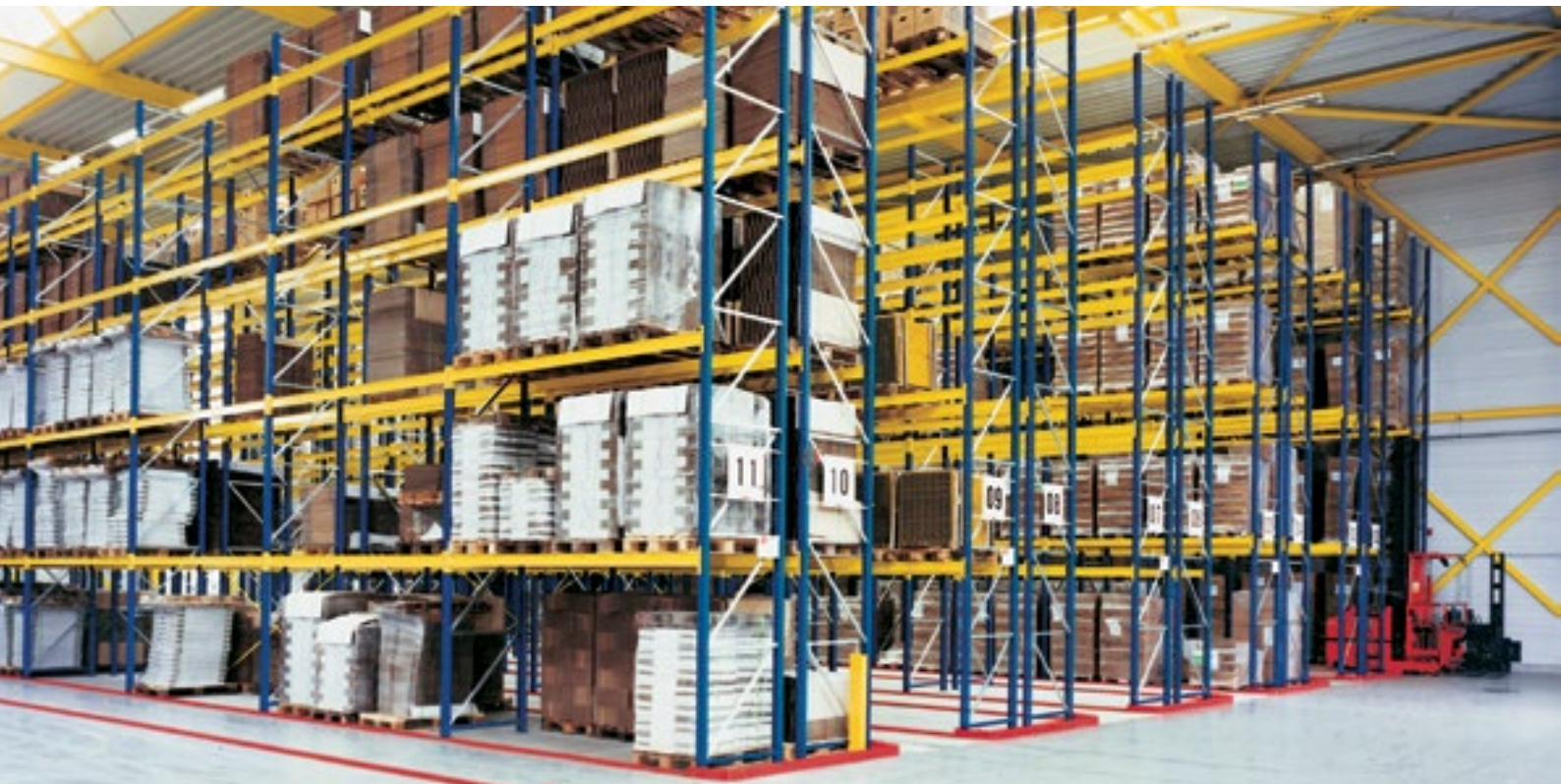
Mehrplatz-Palettenregal mit Führungsschiene aus U-Profil im Logistikzentrum. Branche: Spedition
