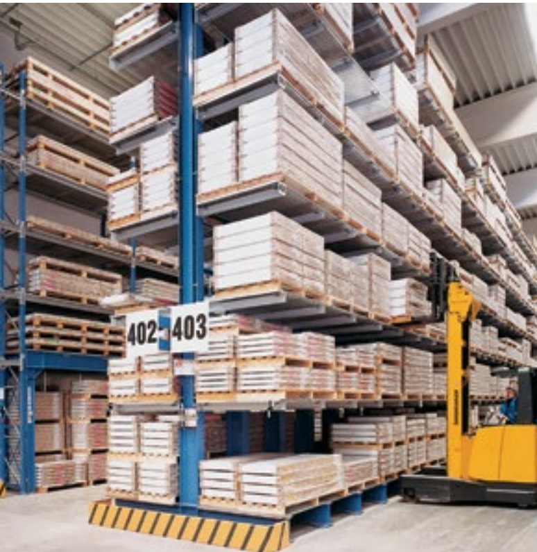
Kragarm-Doppelregal mit Fachebenen aus Gitterroste, dadurch Unabhängigkeit von der Länge der eingelagerten Paletten, durchgehende Lagerebenen ohne störende Kragarmstütze. Branche: Heizungs- und Sanitärgrößhandel
