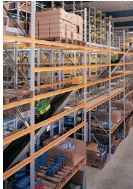
Mehrplatzpalettenregal mit integrierter Förderstrecke. Branche: KFZ-Teilehandel
