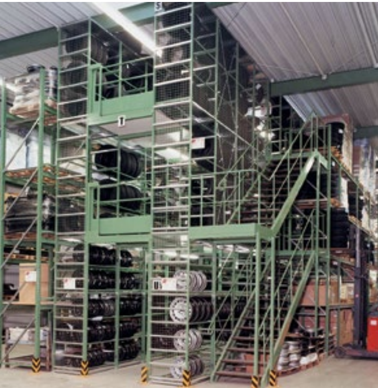
3-geschossige Fachbodenregalanlage mit Treppenaufgang. Branche: KFZ-Teilehandel
