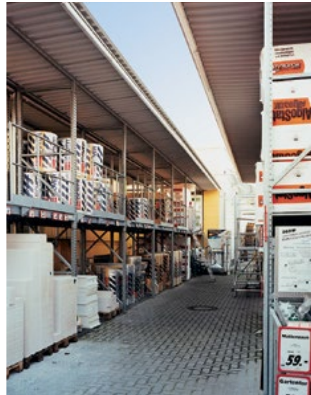
Mehrplatz-Palettenregal Außenaufstellung mit Dacheindeckung.
