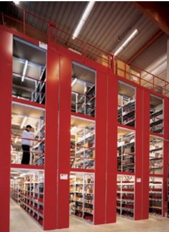
4-geschossige Fachbodenregalanlage mit Lagerbühne, Schutzgeländer, Klapptor und Vollblechstirnwände. Branche: Heizung- und Sanitärgrößhandel
